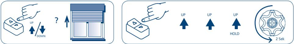
Mit Hilfe der Tasten den Rollläden auf die gewünschte untere Endlage bringen und mit der Taste "DOWN" die beschriebene Befehlssequenz "DOWN-DOWN-DOWN" durchführen.
