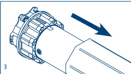
**Bem:** Bei Rundrohren muss der Adapter und Mitnehmer am Rohr befestigt werden. Diese Operation geht zu Lasten des Installateurs. Bei anderen Rohrprofilen ist die Befestigung optional, wird jedoch dringend empfohlen.
