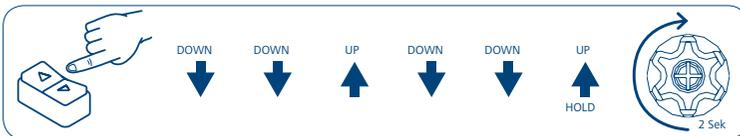
Das Löschen einer oder beider Endlagen hebt sich dadurch hervor, dass der Motor sich kurz bewegt, kurz stoppt, bevor er sich erneut bewegt. Dies bis beide Endlagen erneut eingelernt sind.
