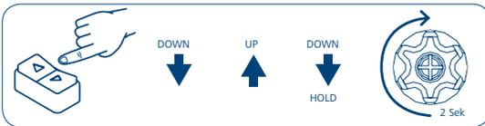
Die genannten Tasten schnell hintereinander drücken, und bei dem mit "HOLD" gekennzeichneten Schritt die Taste gedrückt halten, so dass überprüft wird, dass die Bestätigungsbewegung des Motors durchgeführt wird.
