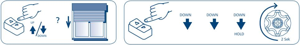
Mit Hilfe der Tasten den Rollladen auf die gewünschte obere Endlage bringen und mit der Taste "UP" die beschriebene Befehlssequenz "UP-UP-UP" durchführen.
