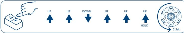
Löschen der UNTEREN ENDLAGE aus der UNTEREN ENDLAGE
