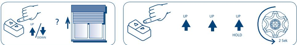
Mit der Ab Taste auf die untere Endlage fahren, der Motor automatisch die Endlage feststellt und stoppt.
